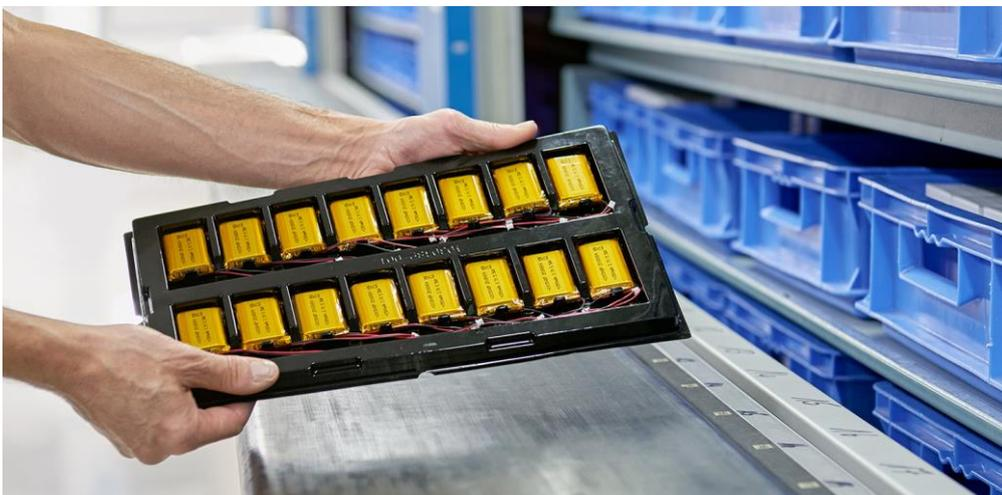
fig. 3. Für einen sicheren Transport von Lithium-Polymer-Zellen werden geeignete Trays verwendet.
